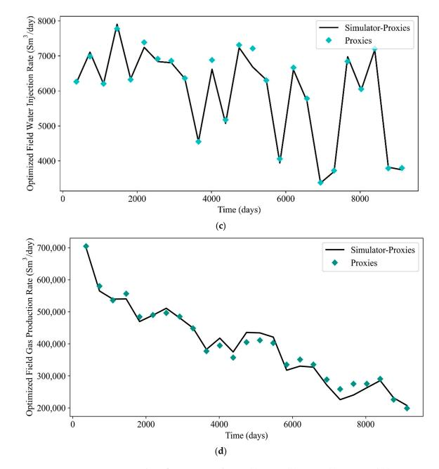
Figure 22. Plots of GA-optimized rates: (a) FOPR, (b) FWPR, (c) FWIR, and (d) FGPR.
