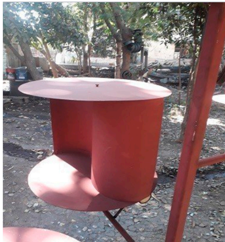
Figure 3. Actual Savonius rotor blade.
