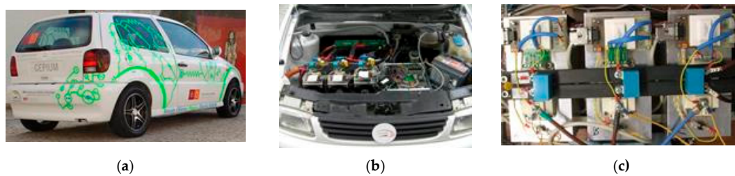
Figure 23. Developed prototype of a plug-in EV (CEPIUM—Carro Elétrico Plug-In da Universidade do Minho): (a) EV prototype; (b) powertrain; (c) power converter detail.
