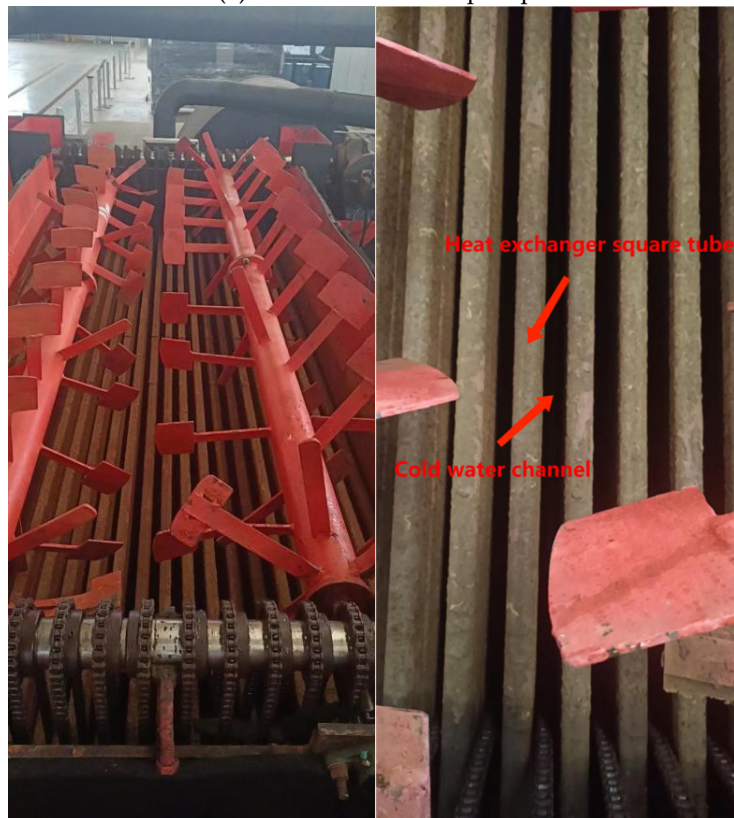
(d) Heat exchanger tube inside the PHCP
